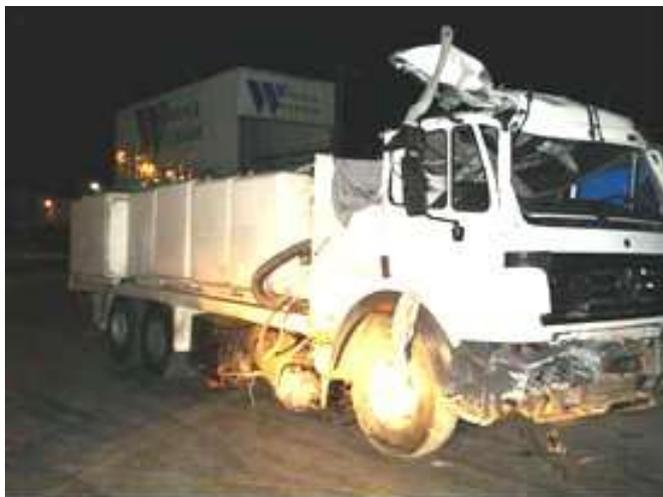
Dans le premier cas, alors qu'il était transporté sur le camion d'un client, un récipient cryogénique clos transportable de 160 litres, en service oxygène, a eu une fuite au col du réservoir intérieur. Le récipient s'est rompu causant de graves dommages à la cabine et au châssis du camion (Photo 1).
