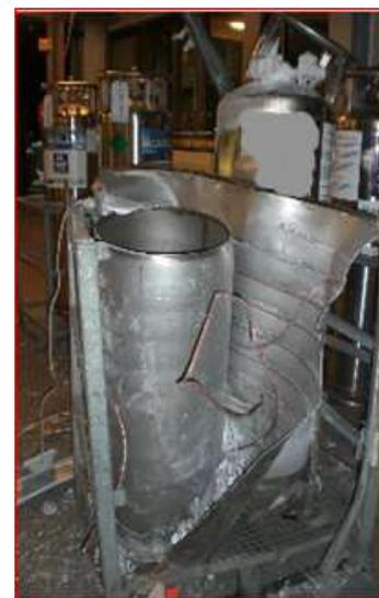
Dans le second cas, un récipient cryogénique clos transportable de 196 litres, en service à l'azote, s'est rompu au centre de remplissage pendant qu'il était sur l'aire de stockage (Photo 2), causant de graves dommages au bâtiment et aux équipements.
